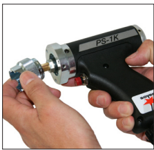
Kontaktschweißpistole PS-1K mit Schnellwechselsystem für Pistolenstützrohre
